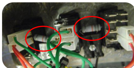
1 resistor de 220 OHMS entre cada botão
