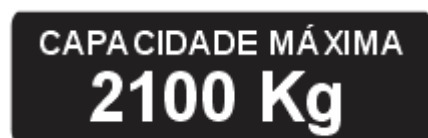
Figura 4 adesivo indicativo de capacidade residual
