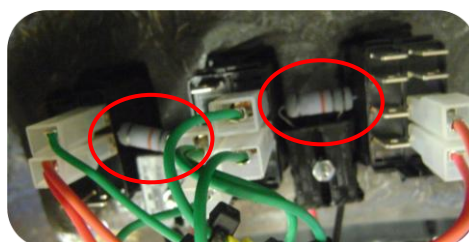
1 resistor de 220 OHMS entre cada botão
