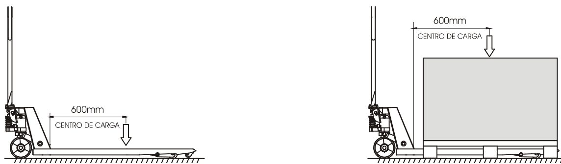
Figura 1 - Centro de Carga
