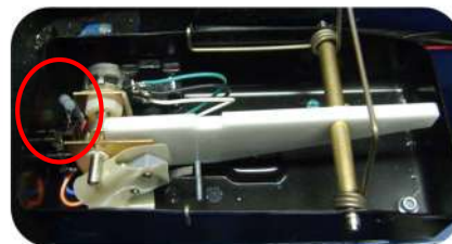
1 resistor 220 OHMS no pedal do acelerador(3)
