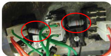
1 resistor de 220 OHMS entre cada botão
