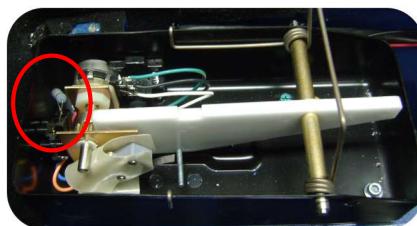
1 resistor 220 OHMS no pedal do acelerador(3)
