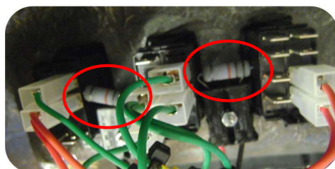
1 resistor de 220 OHMS entre cada botão
