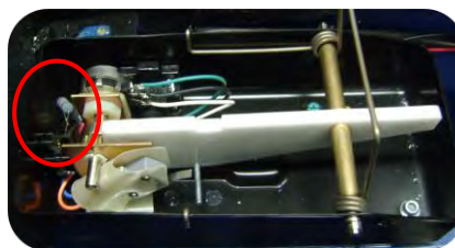
1 resistor 220 OHMS no pedal do acelerador(3)
